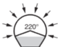
LP částečně perforované drenážní trubky
