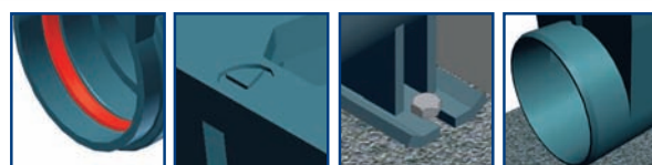
první díl žlábků s těsněním v hrdle označení směru odtoku nohy zajišťující optimální připevnění k základu dlouhý rourový nástavec pro spo- lehlivé utěsnění
